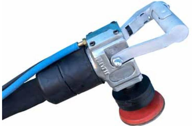
Präsentiert mit einem elektrischen Griff, Schwingungsdämpfer ø 80mm und Diamantplatte
